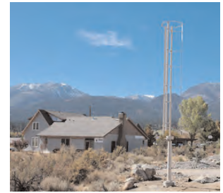
Mariah Power Windspire 1kW turbine
