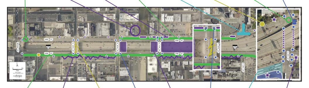
Remove 1 of 3 Travel Lanes and Narrow the Lanes 移除3個車道中 的1個, 並使車 道變窄
